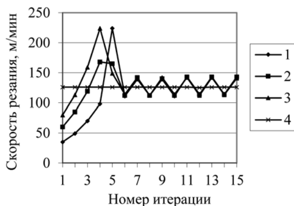
Рис. 2. Процесс сходимости скорости резания к оптимуму в зависимости от номера итерации и начальных значений:
