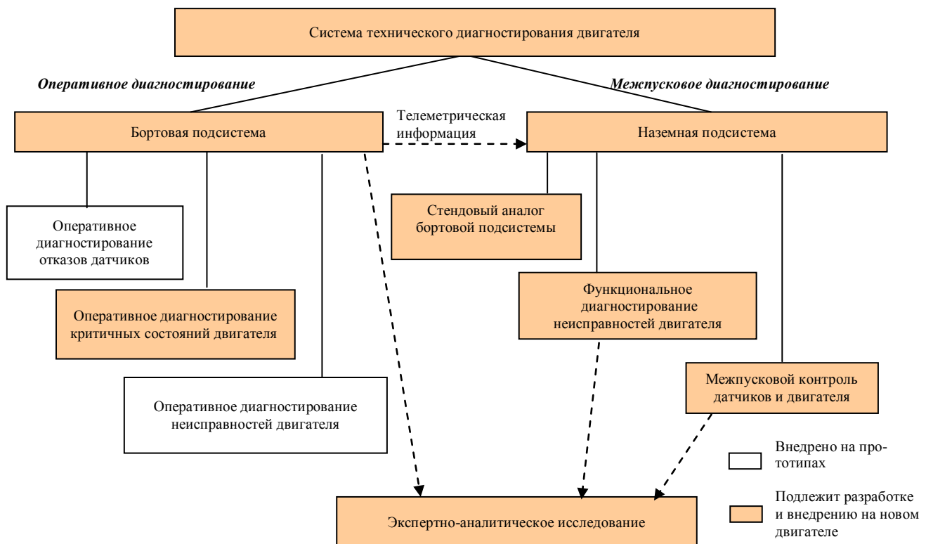
Рис. 1. Структура системы диагностирования двигателя
