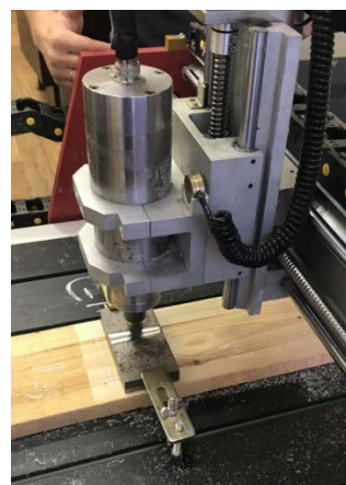
Рис. 6. Обработка стальной пластины на мобильном фрезерном станке SBJ1400, предназначенном для алюминиевых сплавов
